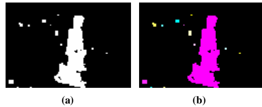
圖 3.2 相鄰元素編號演算法：(a)輸入影像，(b)輸出影像
